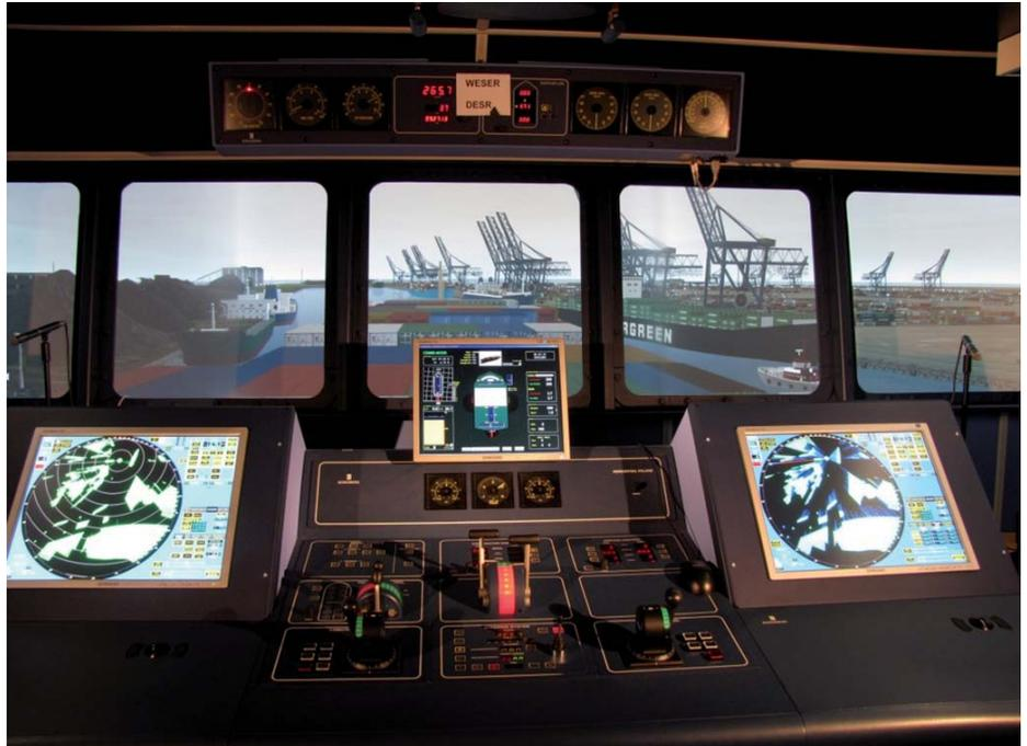
Schiffsführungssimulator des FB Seefahrt: Blick aus einer Brücke
