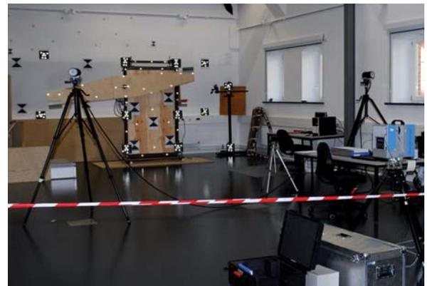
Kombinierte Aufnahme eines Laboraufbaus mit einem Laserscanner und einem optischen Messsystem
