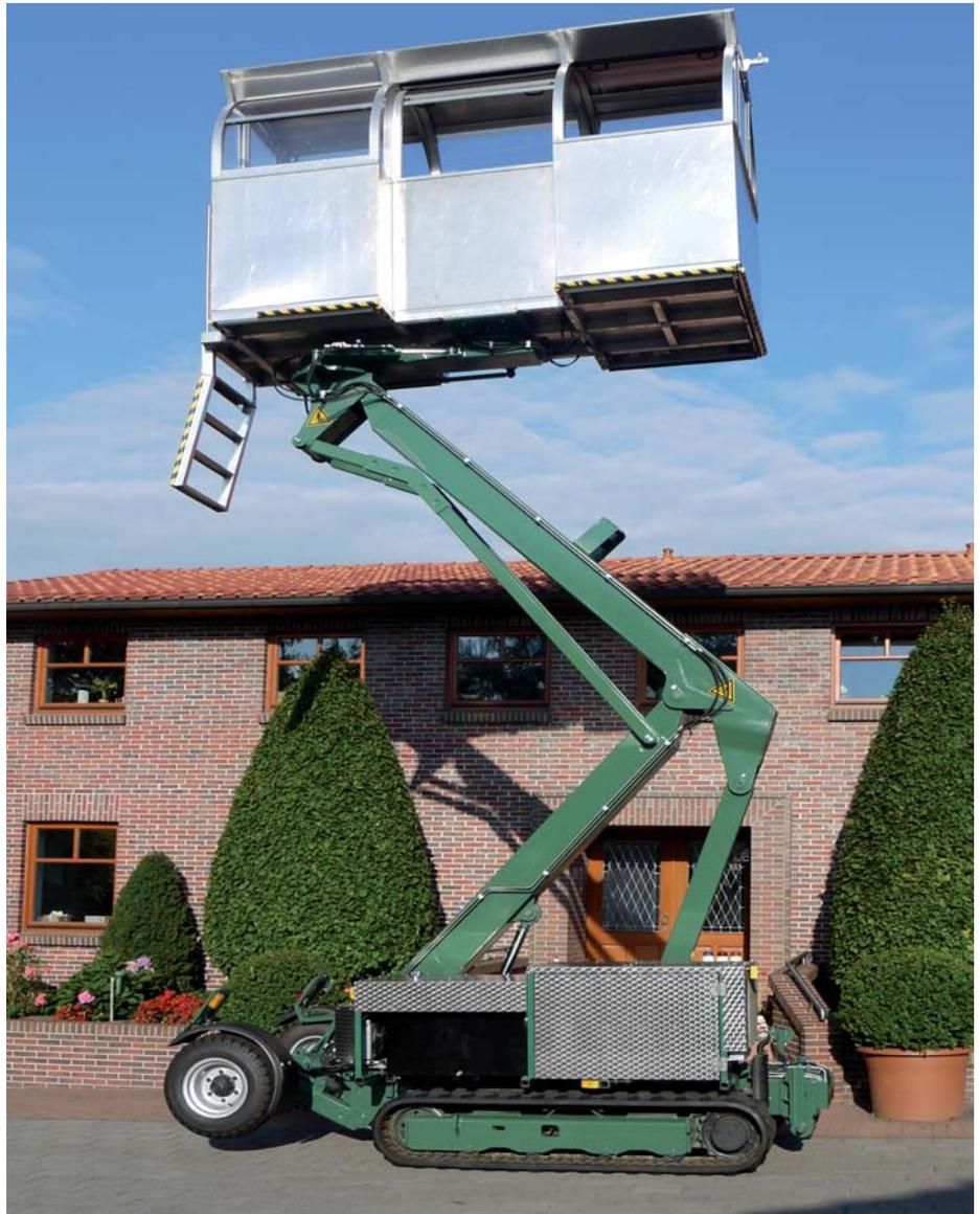
Die entwickelte mobile Hubarbeitsbühne für den Einsatz in Baumschulbetrieben
